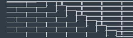
Pose inclinée à recouvrement double
